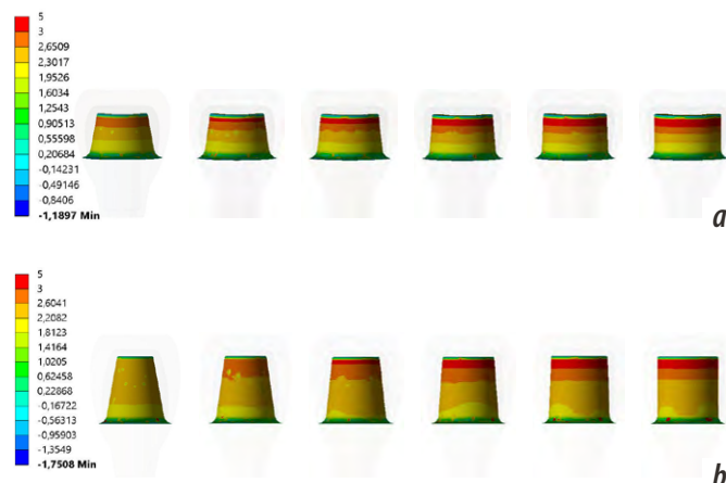
Рис. 15. Остаточные напряжения в цементном слое после фиксации металлокерамических несъемных протезов: а — на одиночной опоре при высоте абатмента 3 мм с углами наклона стенок 10°, 8°, 6°, 4°, 2° и 0°; б — на двух опорах при высоте абатмента 5 мм с углами наклона стенок 10°, 8°, 6°, 4°, 2° и 0°
