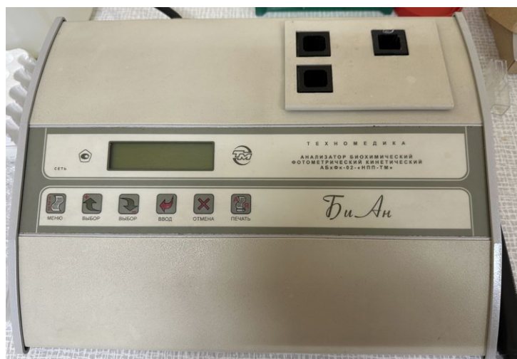
Рис. 2. Анализатор биохимический фотометрический кинетический БиАн Fig. 2. Programmable biochemical analyzer BiAn ("Technomedica", Russia)
