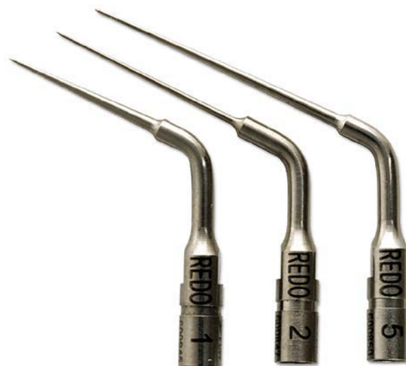
Рис. 12. Насадки REDO: REDO 1 (сталь) для удаления цемента и сломанных инструментов; гибкая REDO 2 (ниобий-титановый сплав) для удаление цемента и сломанных инструментов в апикальной трети канала; REDO 5 (сталь) — для широких каналов
