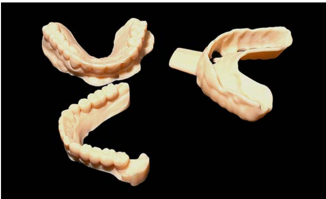
Рис. 7. Модели и слепочная ложка, полученная по технологии 3D-печати [Fig. 7. Models and impression tray obtained using 3D printing]
