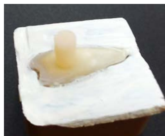
Рис. 2. Образец стеклоиономерного цемента в соединении с дентином зуба для испытания адгезионной прочности методом сдвига
