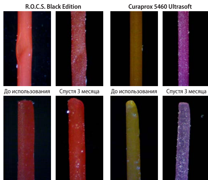
Рис. 3. Изменение внешнего вида текстурированных щетинок из нейлона «Тайнекс» и полиэстера в различные сроки их эксплуатации (ув. 40х)
