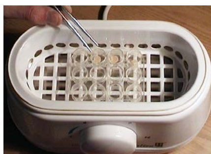
Рис. 4. Обработка образца стоматологического материала Dentokeep Peek в ультразвуковой ванне
