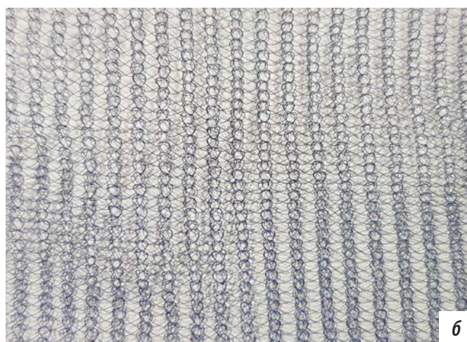
Рис. 2. Сетка для армирующей пластики мягких тканей «Титановый шелк», использованная в клиническом примере: а — общий вид; б — вид плетения под увеличением
