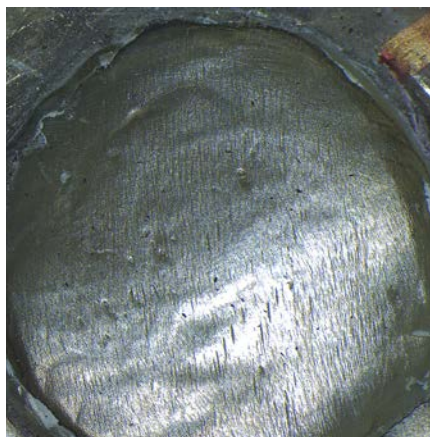
Рис. 9. Образец после шлифовки диском II группы
