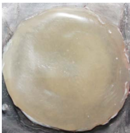
Рис. 5. Образец после контурирования диском IV группы
