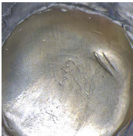
Рис. 7. Образец после шлифовки диском I группы
