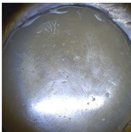
Рис. 10. Образец после шлифовки диском IV группы
