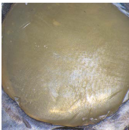
Рис. 8. Образец после шлифовки диском III группы
