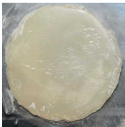
Рис. 3. Образец после контурирования диском I группы
