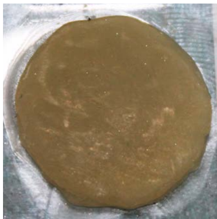
Рис. 1. Образец полимеризованного фотокомпозиата до полировки
