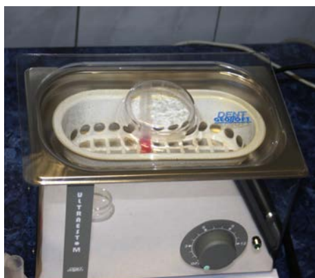
Рис. 3. Обработка образца стоматологической пластмассы с тест-штаммом в ультразвуковой ванночке «UltraEst-M» (ООО «Геософт», РФ)
