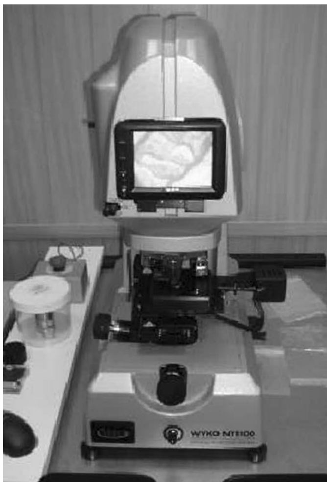
Рис. 2. Оптический профилометр Optical profiling system Veeco WYKO NT1100
