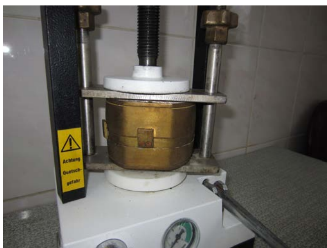
Рис. 9. Кювета в сборе с расширительным кольцом выдерживается в прессе по общепринятой методике
