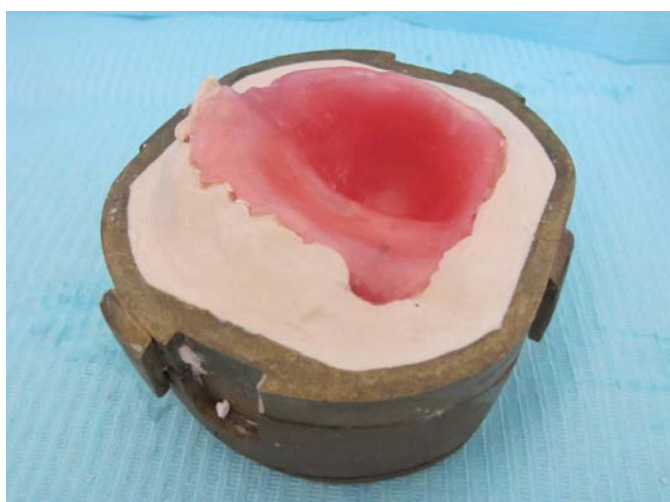
Рис. 6. Жесткий базис загипсован в кювету в сборе с расширительным кольцом. Края восковой композиции совпадают с краями бортов кюветы
