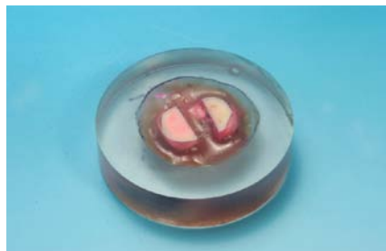
Рис. 1. Образцы, подготовленные для лазерного конфокального сканирующего исследования
