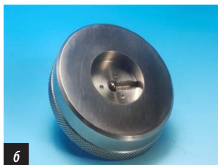
Рис. 2. Устройство для микрошлифования образцов: а) вид сверху; б) вид снизу
