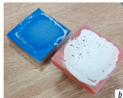
Внешний вид образца 1 после испытаний: а) на подложке 3D через 12 часов, б) на подложке ПММА через 24 часа
