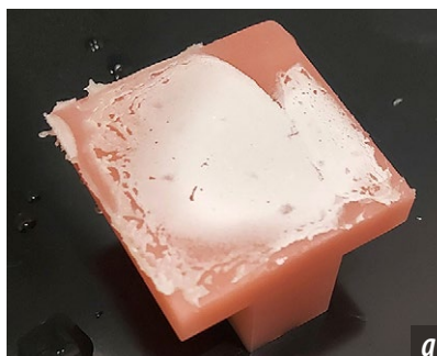
Внешний вид образца 1 после испытаний: а) на подложке 3D через 12 часов, б) на подложке ПММА через 24 часа
