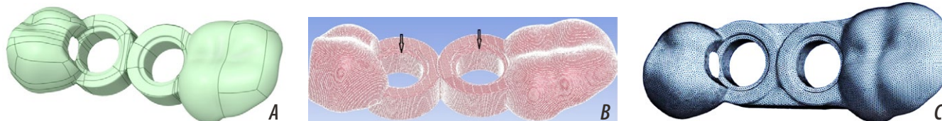
Рис. 4. А — фасетная модель из порядка 200 тыс. элементов, В — твердотельная модель варианта 1, С — конечноэлементная модель варианта 2
