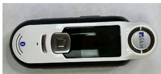
Рис. 1. Прибор для определения цвета Capsure RM200 (X-Rite, США)
