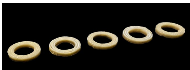
Рис. 2. Образцы из ПЭЭК диаметром 5 мм и высотой 2 мм Fig. 2. PEEK specimens, 5 mm in diameter and 2 mm in height
