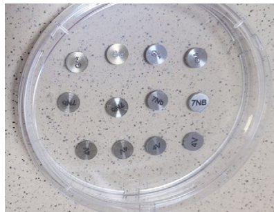
Рис. 1. Исследуемые титановые образцы (диаметр 8 мм, высота 1,5 мм) с рабочей маркировкой в стерильной чашке Петри Fig. 1. Test titanium samples (8 mm diameter, 1.5 mm height) with working marking in a sterile Petri dish
