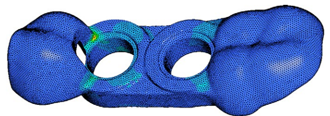
Рис. 10. Вариант 2. Материал Formlabs. Нагрузка 30 Н на левое кольцо, \sigma_{\max} = 16,27 МПа
