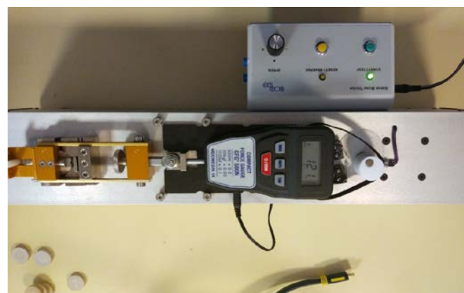
Аппарат для измерения прочности связи при сдвиге Shear Bond Tester
