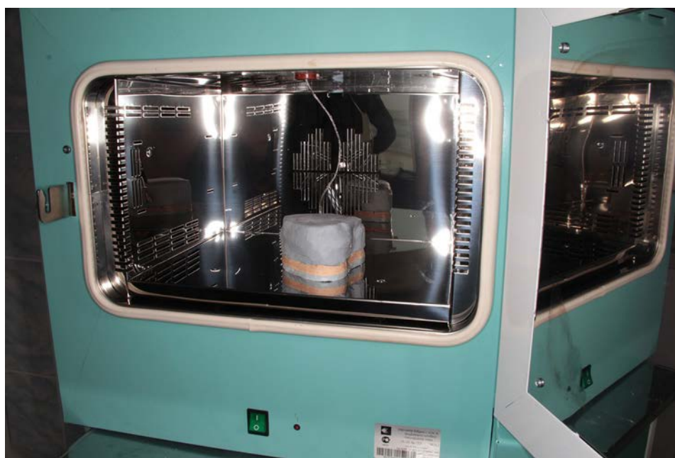
Рис. 2. Полимеризатор со встроенной термопарой и регулятором температуры
