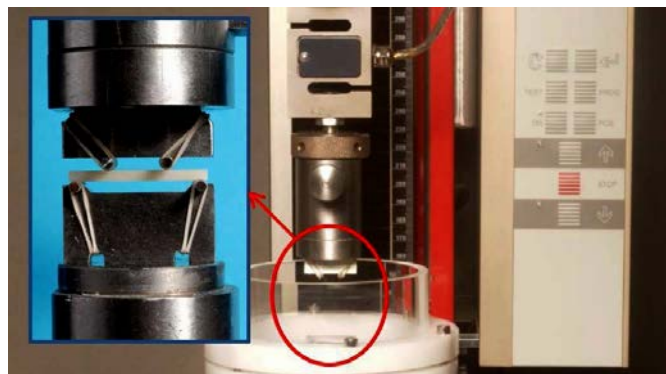
Рис. 2. Универсальная машина для испытания материалов ZW 2.5/TN1S. Увеличенное изображение показывает керамическую палочку между опорами и прижимными штампами для определения прочности при изгибе в 4 точках
